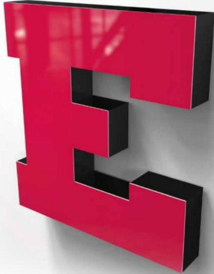
Die Buchstabenseite des Modells P besteht aus einem flachen Aluminiumband, mit dem sich jede, auch die komplizierteste Form biegen lässt. Die Vorderseite besteht aus einer glatten und ästhetischen Plexiglas Opal, und das Fehlen einer sichtbaren Kante betont den Minimalismus der Form. Die Buchstaben und Logos des Modells P können auch in der Version mit Plexi Day & Night hergestellt werden.
